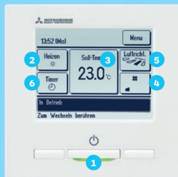
Kabelfernbedienung RC-EX3 mit Touchoberfläche und vielen weiteren Zusatzfunktionen (z. B. Auskühlungs-/Überhitzungsschutz, USB-Schnittstelle, Klartext-Menüführung in Deutsch und sieben weiteren Sprachen)
