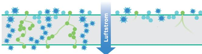
Ein Enzymfilter zerstört die Zellwände der in der Raumluft befindlichen Bakterien, Pilzsporen und Allergene und baut diese biologisch ab.
